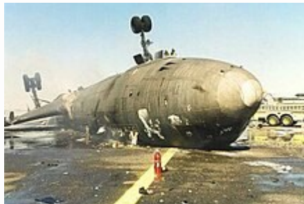
図.3 フェデックス14便 (MD-11貨物機) の着陸時転倒事故
