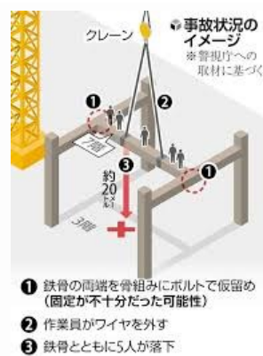
図.2 事故の発生状況
