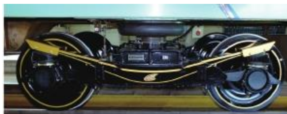
図2 CFRP製の板バネをもつ JR 西日本車両の台車
