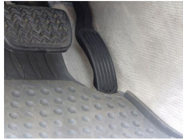
図.2 レクサスのアクセルペダルとフロアマットの干渉 (トヨタによる報告)
