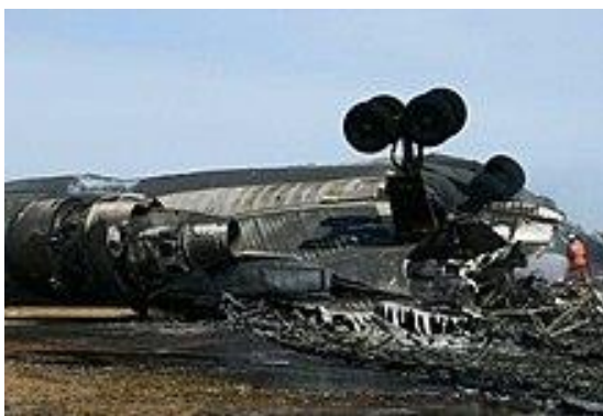
図. 3 LSASの誤作動で逆さになったフェデックス80便 (MD-11)
