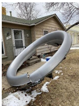
図.2 住宅地に落下したエンジンのインレットカウル
