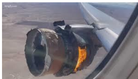
図.1 破損した328便の右側エンジン
